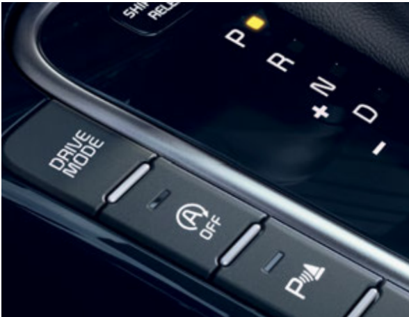
Выбор режима движения (DMS). Поднимите удовольствие от вождения на новый уровень, выбирая режим вождения с помощью кнопки, расположенной рядом с селектором передач. Усиливая отклик дроссельной заслонки на старте и оптимизируя производительность при обгоне, система значительно повышает динамику. DMS также обеспечивает более острую реакцию на поворот руля и компенсирует инерцию шин, чтобы обеспечить более активное движение.
