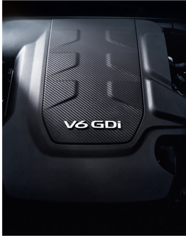
Двигатель Lambda 3.3 V6 GDi Макс. мощность: 249 л. с. @ 6000 об/мин Макс. крутящий момент: 347 Н·м @ 5000 об/мин
