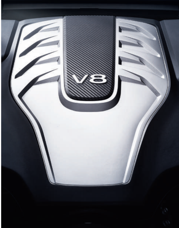
Двигатель Тау 5.0 V8 GDi Макс. мощность: 413 л. с. @ 6000 об/мин Макс. крутящий момент: 505 Н·м @ 5000 об/мин
