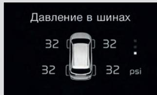
**Система контроля давления в шинах (TPMS)**
