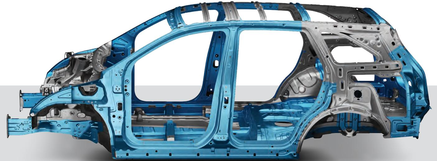
**52.7%** доля высокопрочных сталей в конструкции
